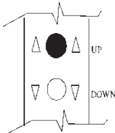
De takel wordt bediend door middel van een controlestation met specifieke omhoog en omlaag knoppen zoals aangegeven in het volgende schema:
