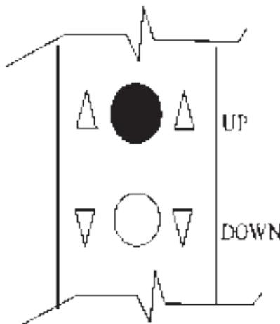
Le palan est commandé via une boîte à boutons spécifique qui comprend un bouton haut et un bouton bas tel que représenté sur le schéma suivant:
