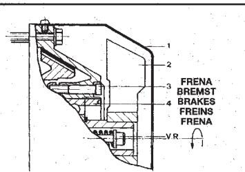
Die Bremskraft wird durch Verstellen der entsprechenden Stellschraube (V.R.) eingestellt, die auch zum Lösen des Motors dient. Zum Erhöhen der Bremskraft die Schraube gegen den Uhrzeigersinn drehen.
