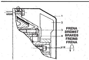
La force de freinage est réglée en ajustant la vis de réglage (V.R.) prévu à cet effet et qui sert aussi à débloquer le moteur. Pour augmenter le freinage, tourner la vis dans le sens inverse des aiguilles d'une montre.
