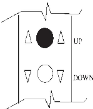
Die Seilwinde wird durch eine spezielle Steuertafel gesteuert, die über eine Auf- und Ab-Taste verfügt, wie folgende Abbildung zeigt:
