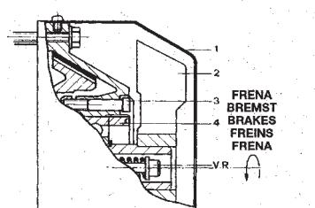
De remkracht wordt geregeld door de voor dit doel voorziene stelschroef (V.R.) die eveneens dient om de motor te ontgrendelen. Om de remkracht te verhogen draait u de schroef tegen de wijzers van de klok in.
